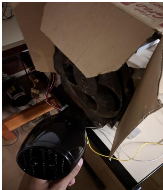
Figura 11 – Secador de cabelos (fonte de ar quente). Fonte: Pesquisa direta (2019).
