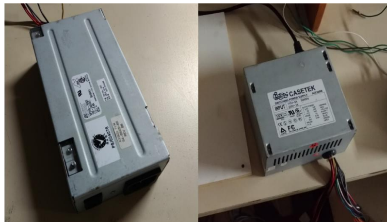
Figura 9 – Fontes de energia 23,04 W (a esquerda) e 40,2 W (a direita). Fonte: Pesquisa direta (2019).
