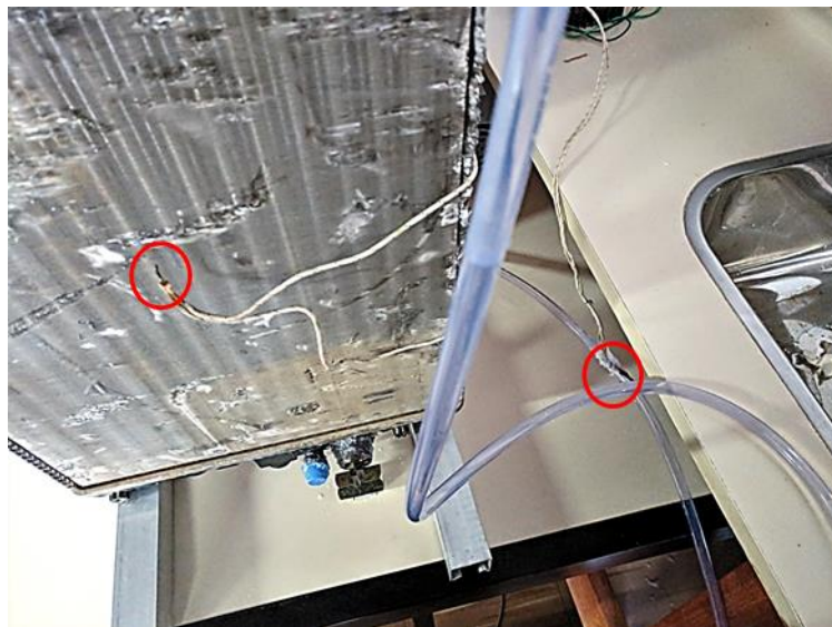
Figura 13 – Par de termopares. Fonte: Pesquisa direta (2019).
