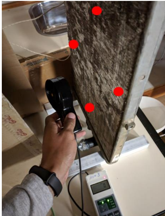
Figura 16 – Anemômetro de ventoinha e pontos de coleta (pontos vermelhos). Fonte: Pesquisa direta (2019).
