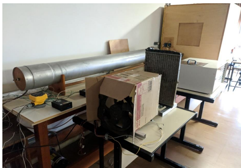
Figura 17 – Bancada completa com canalização do ar. Fonte: Pesquisa direta (2019).
