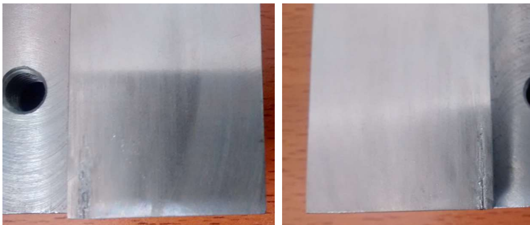
Figura 37 - Desgaste nos colchetes. Fonte: Pesquisa Direta (2019)
