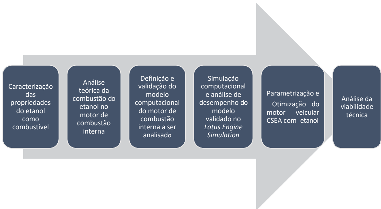
Figura 9- Fluxograma para a análise técnica da combustão do etanol em um motor de combustão interna a diferentes razões de compressão.
