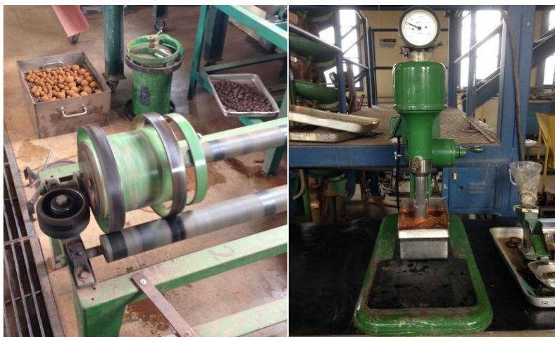
Figura 4.1: Carcaça de moinho tubular e célula de flotação, respectivamente. Equipamentos estes utilizados nos ensaios de desagregação em escala de laboratório.
