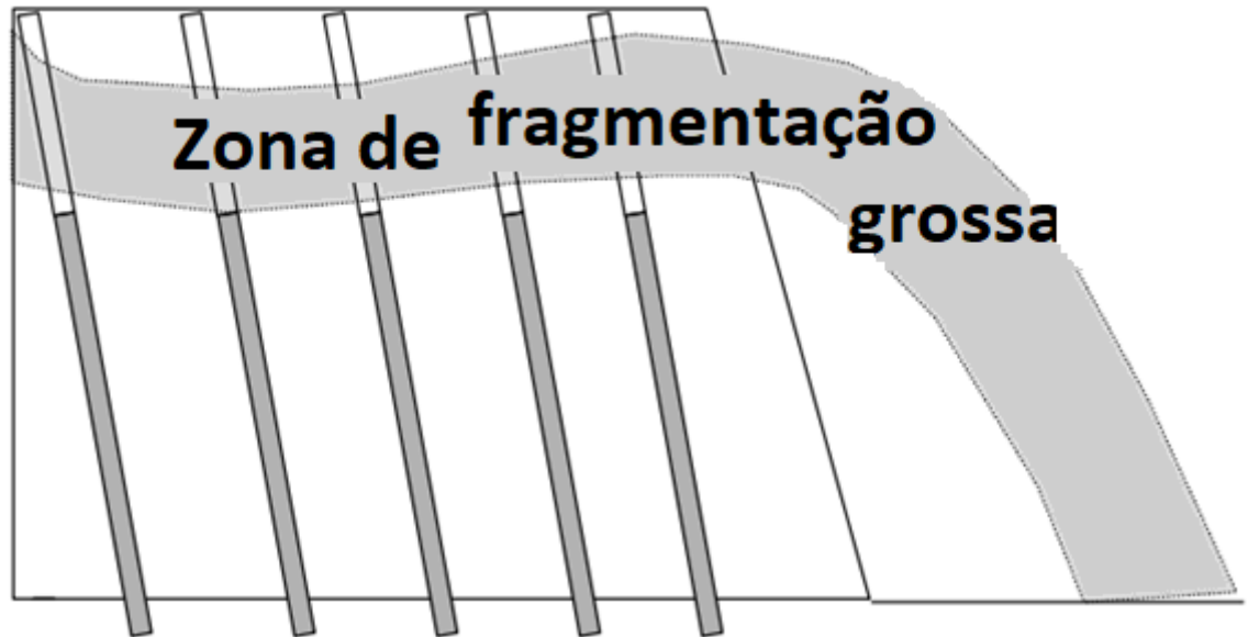
Figura 26 – Formação da zona de geração de fragmentos grossos num desmonte, causado pelo efeito do tamponamento. Fonte: Kanchibotla et al. (1999)
