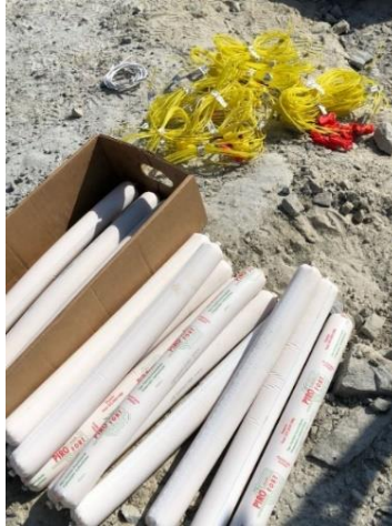
Figura 29 - Emulsão encartuchada utilizados no desmorte em caso de trincas no banco e cordéis detonantes.
