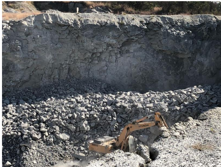
Figura 30 - Frente de lavra e pilha desmontada. Fonte: Própria.
