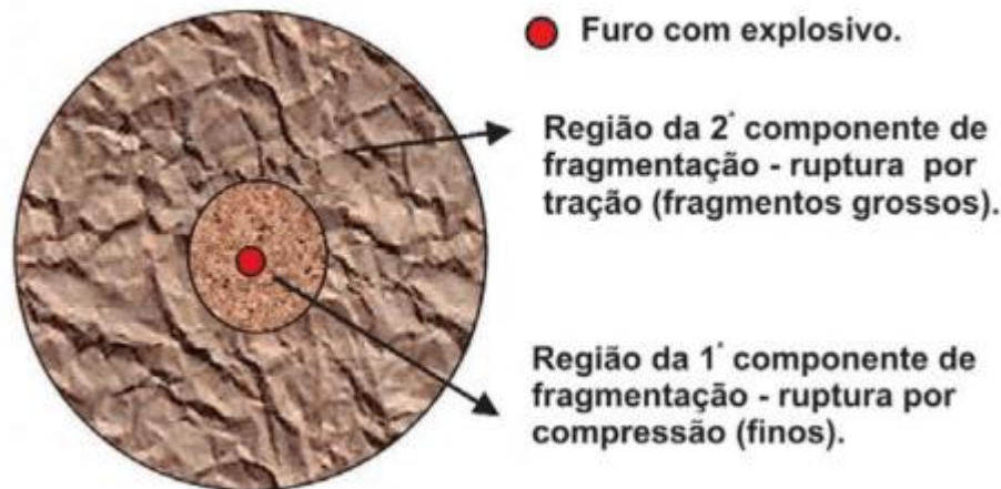
Figura 3.25 - Regiões que sofrem fraturamento na detonação. Fonte: Morais (2004).
