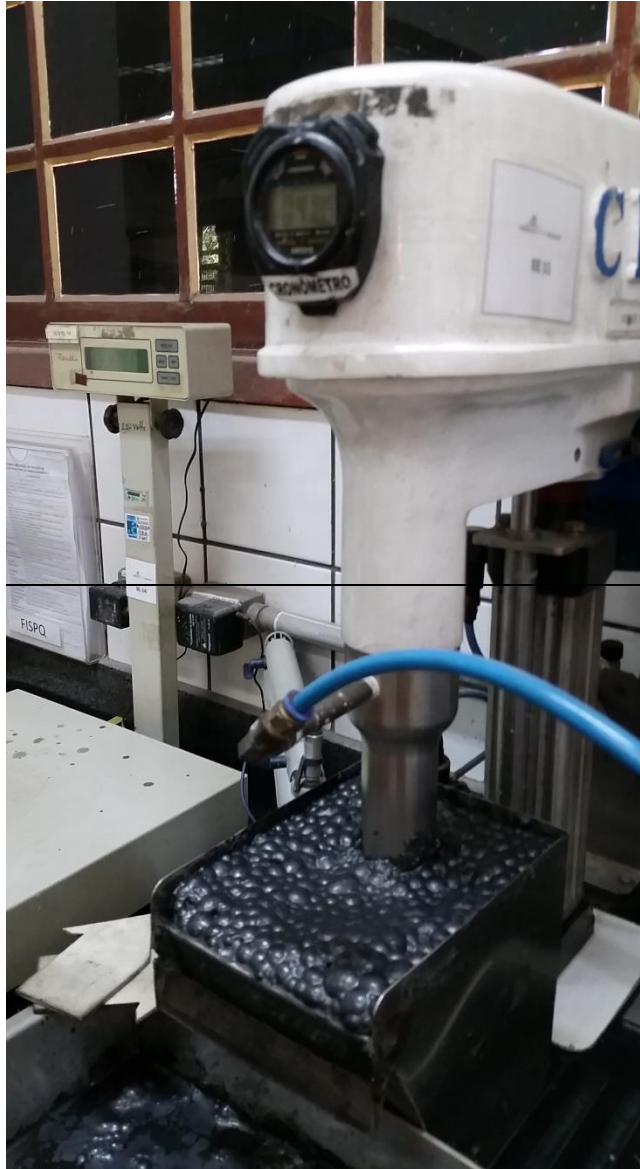
Figura 4.2: Teste de flotação em bancada. Fonte: Elaborada pelo autor.
