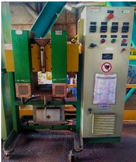
Figura 16 - Separador magnético WHIMS.
