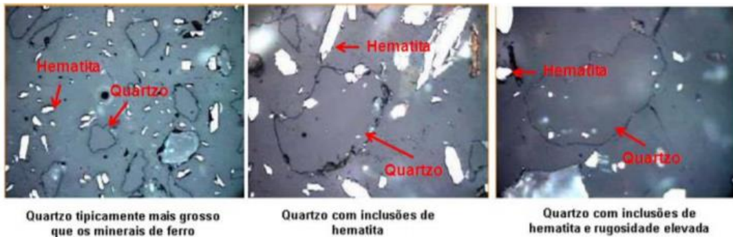
Figura 5 - Características de quartzo grosso, com inclusões de óxido ferroso e rugosidade elevada.
