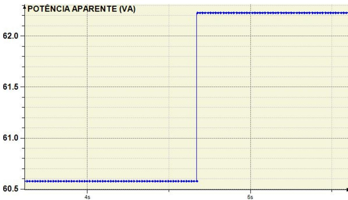
Figura 31 – Potência aparente da lâmpada incandescente.
