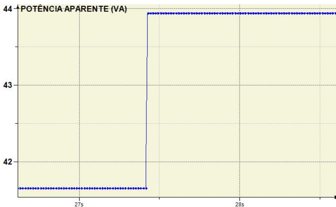
Figura 26 – Potência aparente da lâmpada fluorescente.
