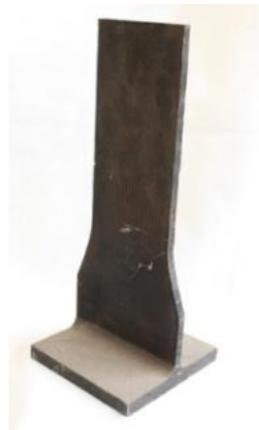
**Figura 6.6:** Perfil T utilizado na fixação dos tubos
