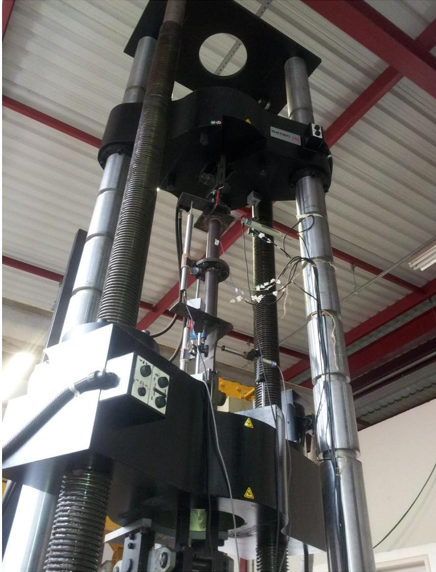
**Figura 6.4:** Tubofixado na prensa hidráulica
