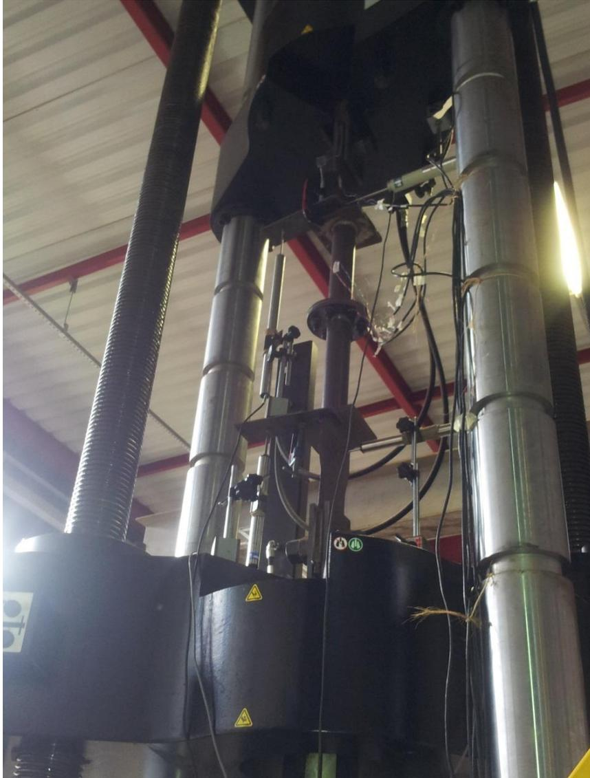
**Figura 6.3:** Tubofixado na prensa hidráulica
