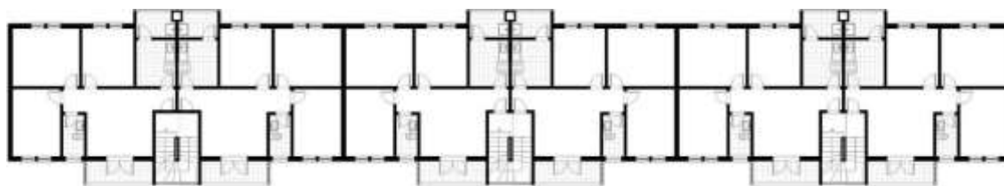
Figura 11 – Planta do segundo pavimento do edifício W6 do conjunto do Realengo, refeita a partir de estudo da modelagem eletrônica da edificação. Fonte: Habitação Social . 12
