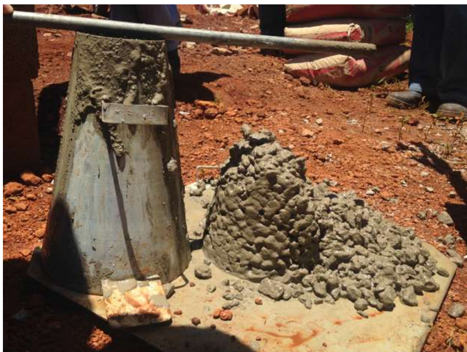
Figura 29: Slump Test CP 1 , sem ajuste
