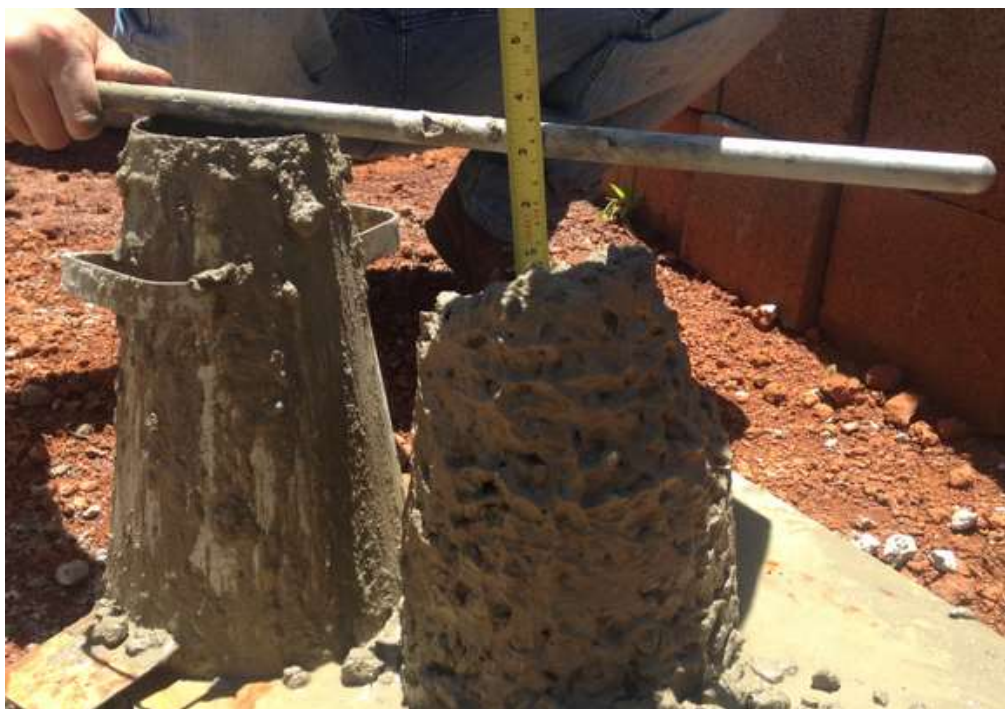
Figura 30: Slump Test CP 1 , com ajuste.
