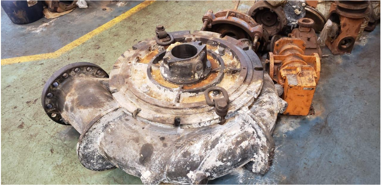
Figura 10: Manutenção de uma bomba Fonte: Pesquisa direta (2018)
