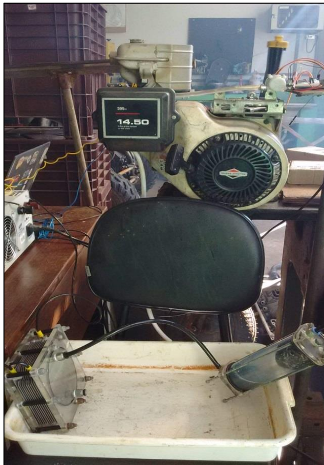
Figura 17: Bancada para análise de consumo de combustível.
