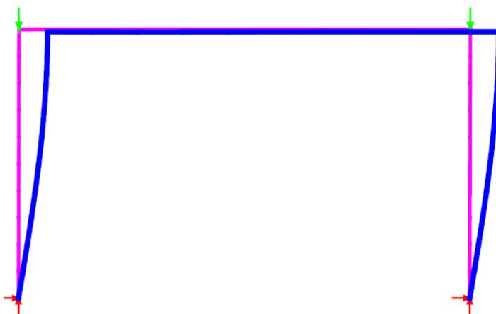
**Figura 13 – Configuração deformada do pórtico apresentada pelo Mastan2.**
