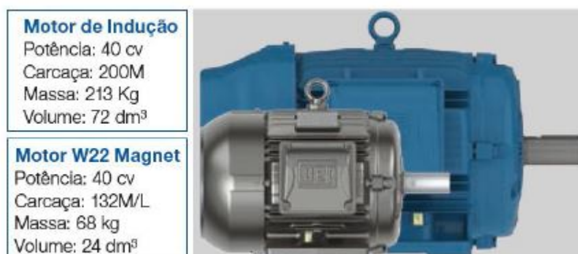
Figura 27 – Comparativo entre as máquinas de indução e síncronas de ímãs-permanentes da fabricante WEG.
