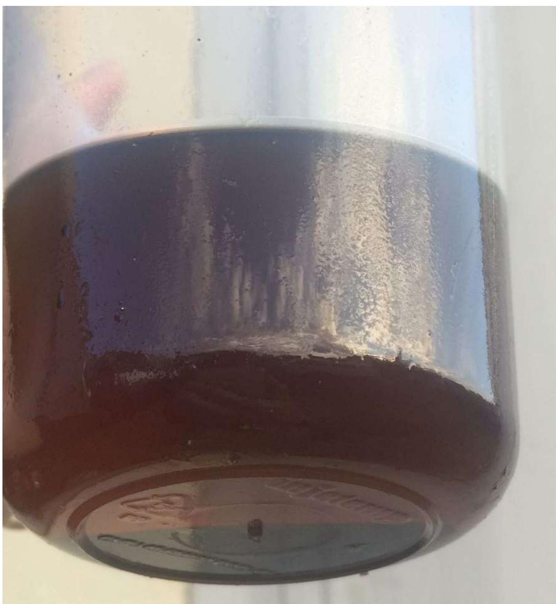
Figura 19 - Mistura Diesel e Bio-óleo, com precipitação de Bio-óleo Fonte: Pesquisa Direta, 2018
