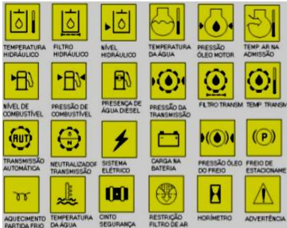
Figura 29: Simbologia universal do painel de instrumentos de uma pá-carregadeira. Fonte: Silva (2017)
