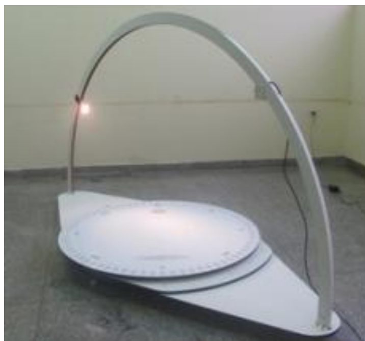
Figura 3 - Heliodon com rotação vertical. Fonte: UNIGRAN ..., 2010
