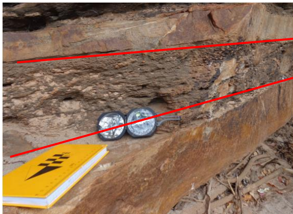
Figura 3.16 – Acamamento sedimentar evidenciado pelo contato erosivo entre as litofácies, marcado pela linha em vermelho na foto.
