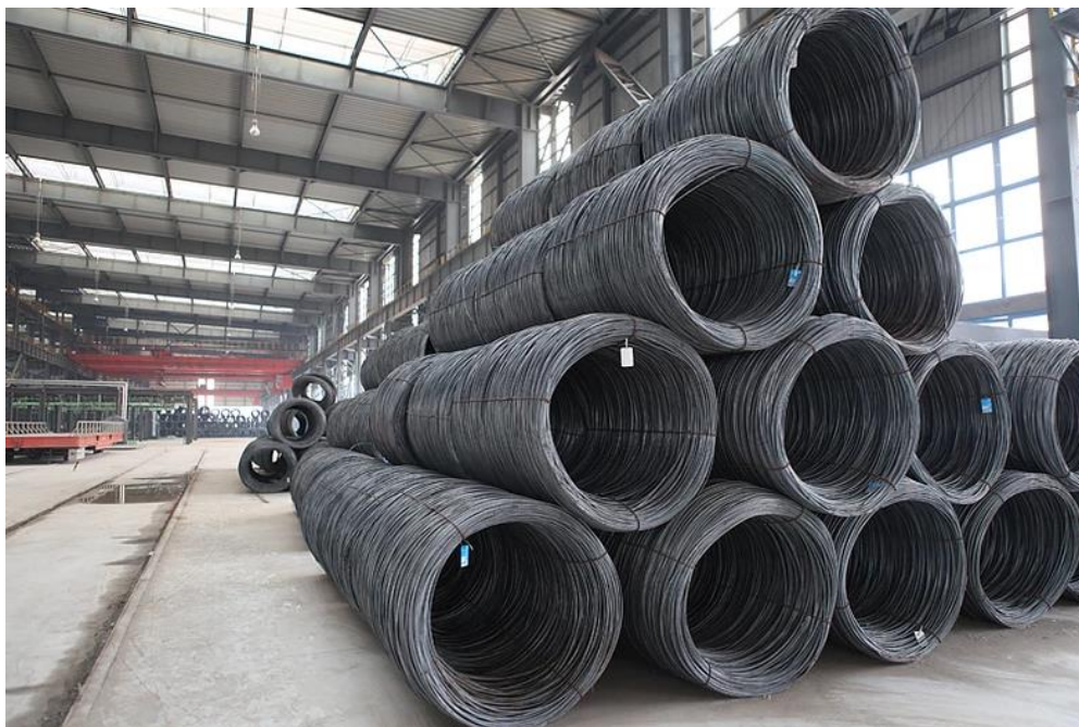
Figura 5 - Estocagem de fio-máquina Fonte: Dhahi Steel (2018)
