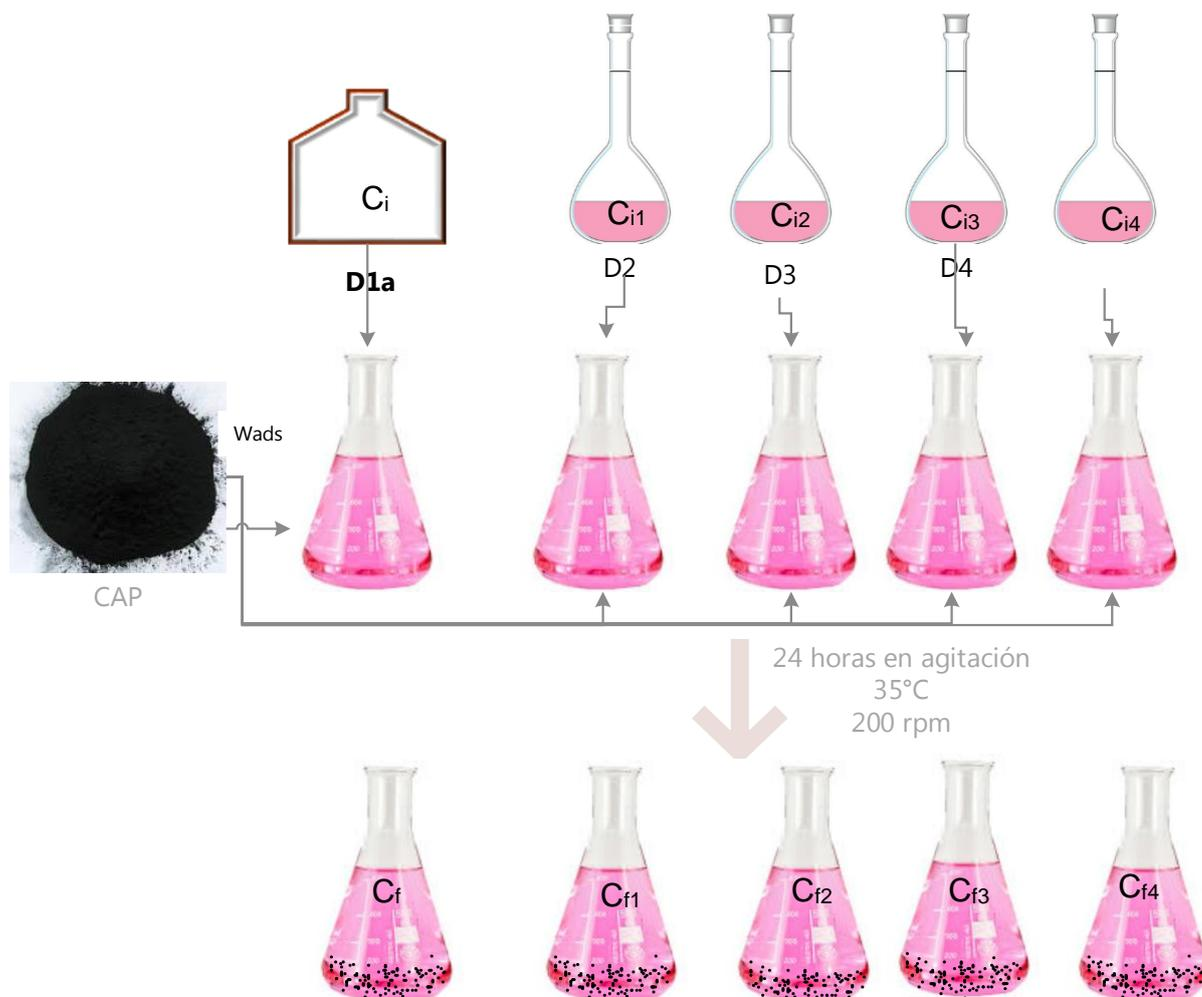
Fuente: el autor;  $C_i$  y  $C_f$  son alícuotas del hidrolizado antes y después del ensayo
