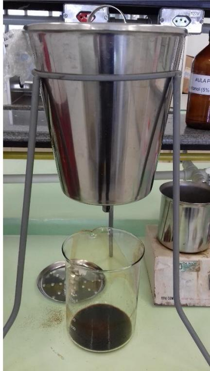
Figura 9. Processo de percolação em etanol da casca de *M. urundeuva*.
