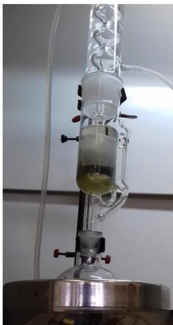
Figura 10. Fracionamento do extrato etanólico bruto da casca de *M. urundeuva* em aparato de Soxhlet.
