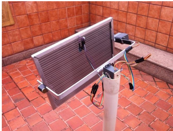
Figura 3-2 - Plataforma Montada com os Servos e o Sensor MPU-6050
