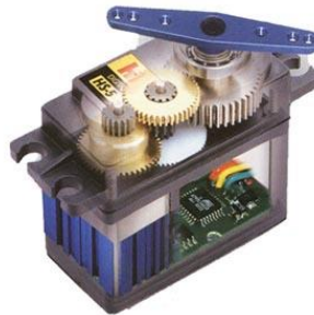
Figura 2-4 - Visão da Caixa de Redução e do Circuito de Controle de um Servomotor Fonte: ENGLEANDROALVES, 2015
