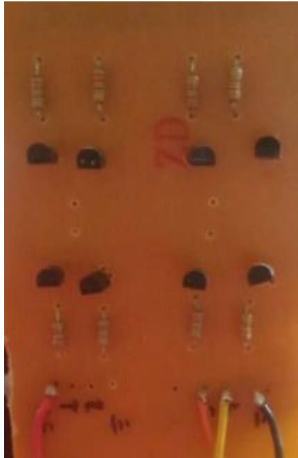
Figura 19 – Circuito das pontes H na placa de fenolite.
