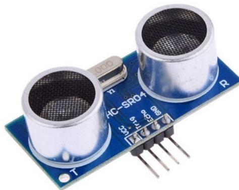
Figura 7 – Sensor de Distância Ultrassônico HCSR04
