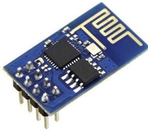
Figura 6 – Módulo Esp8266 modelo ESP-01
