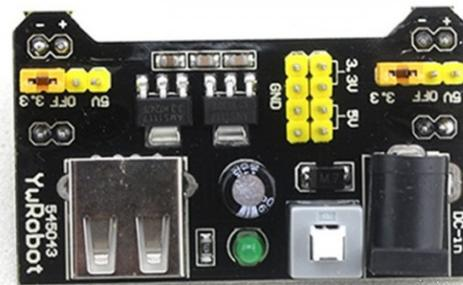
Figura 9 – Fonte de alimentação Mb102 - YwRobot
