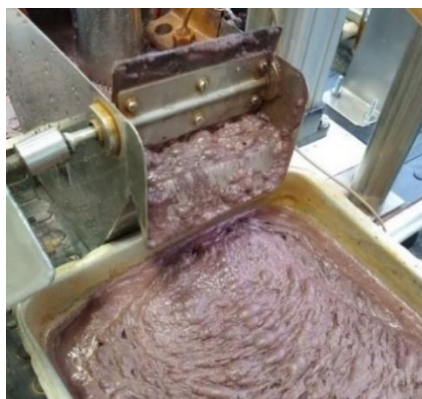
Figura 10 - Remoção da espuma resultante da flotação do itabirito dolomítico.
