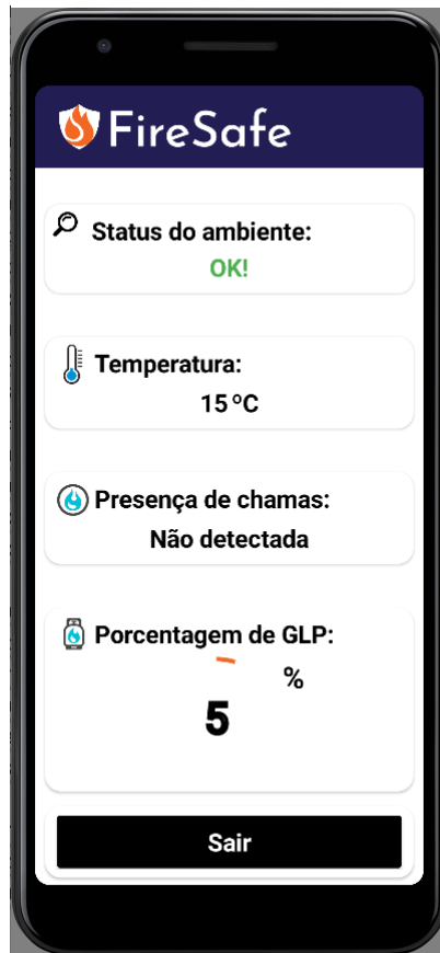
Figura 37 – Tela de monitoramento do aplicativo FireSafe . Fonte: Autoria Própria
