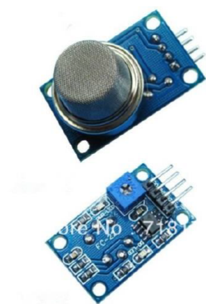
Figura 13 – Sensor MQ-6 Fonte: ( PINTO, 2016 )
