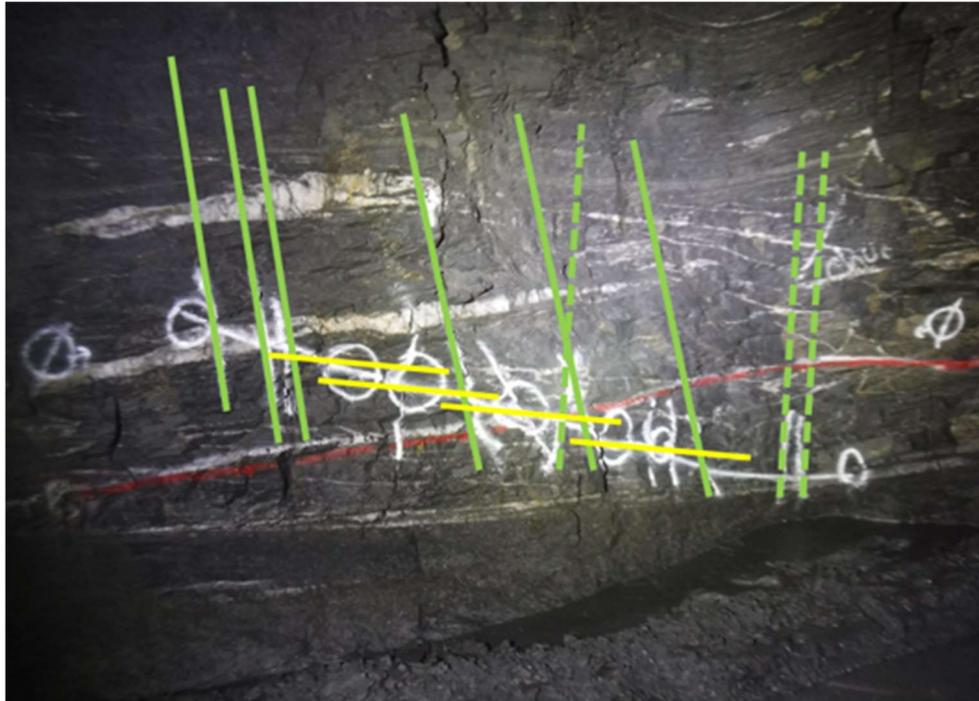
**Figura 19** – Mapeamento geotécnico realizado. Onde linhas com traços e cores diferentes representam famílias de descontinuidades.
