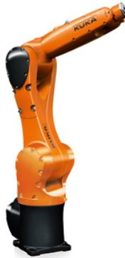
Figura 4: Foto do Robô KUKA KR 6 R900 sixx usado em simulador para os experimentos
