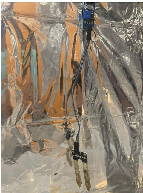
Figura 14 – Sensor de umidade do solo - Higrômetro.
