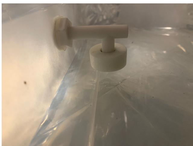
Figura 13 – Sensor de nível do tipo boia.
