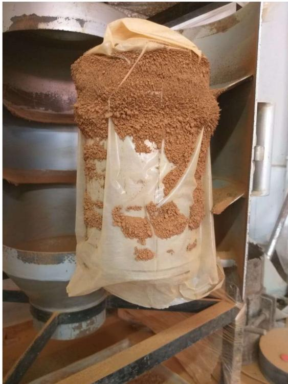
Figura 8 - Beneficiamento de areia ferrosa no separador magnético tipo tronco de cone
