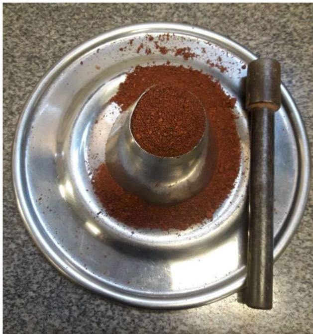
Figura 12 - Absorção de água da AF
