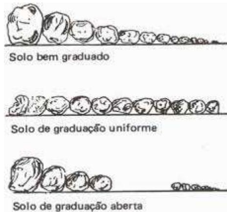
Figura 4 - Graduação do solo - Fonte: Análise granulométrica do Solo - Filipe Marinho, 2020, Guia da Engenharia.
