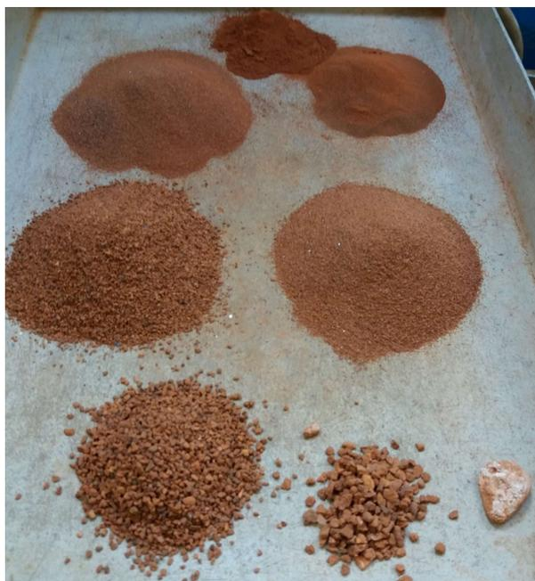
Figura 9 - AF em frações separadas pelo ensaio de granulometria
