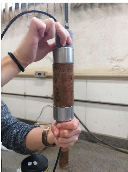
Figura 16 - Ensaio de Velocidade de Pulso Ultrassônico de CAF-533
