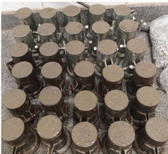
Figura 13 - CAF-425 moldado e adensado antes de ir para câmara úmida
