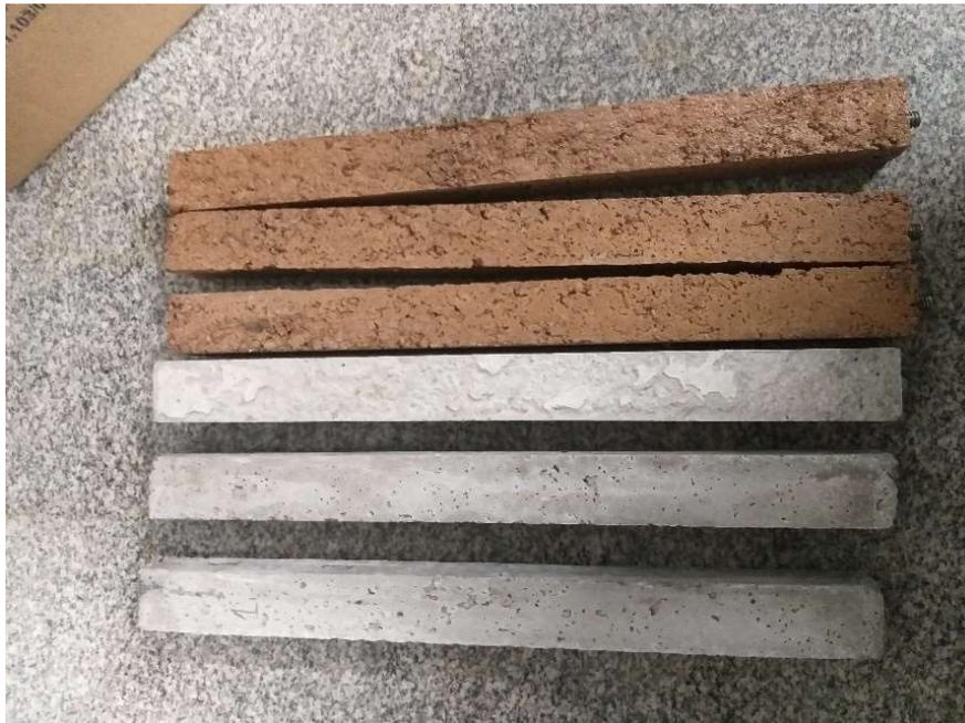
Figura 24 - Corpos de prova após serem submetidos ao ensaio de expansibilidade na autoclave
