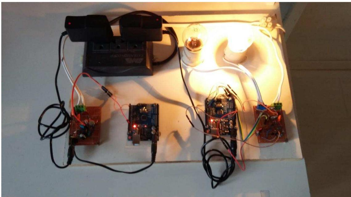
**Figura 41 – Montagem dos circuitos de comunicação por Protocolo X10**
