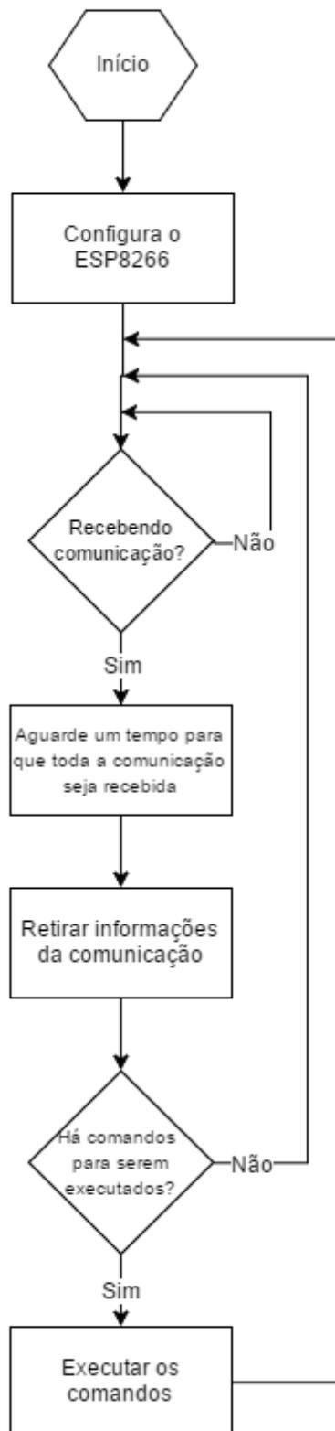
Figura 44 – Fluxograma da programação do arduino
