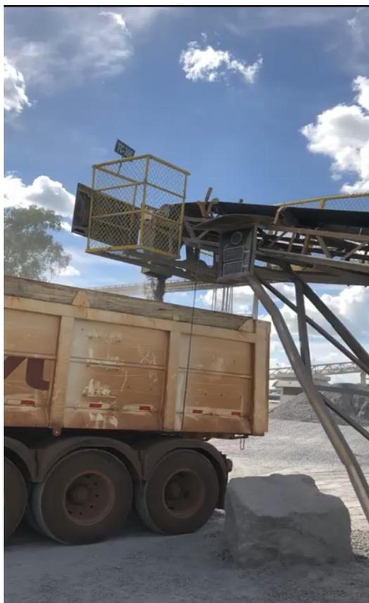
Figura 14 - Balança integradora de correia que realiza carregamento de um caminhão. Fonte: autor.
