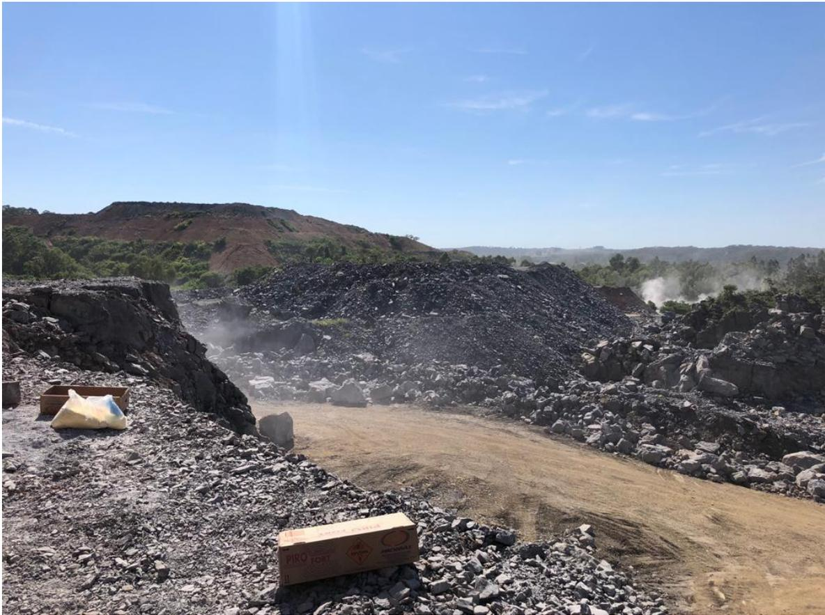
Figura 19 - Pilha de estéril do calcário magnesiano. Fonte: autor.
