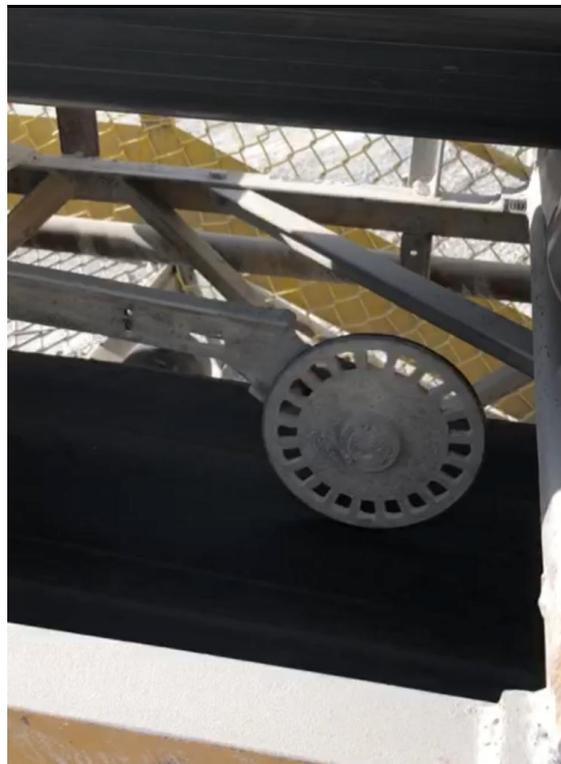
Figura 5 - Foto do gerador de pulsos de uma balança integradora de correia. Fonte: autor.
