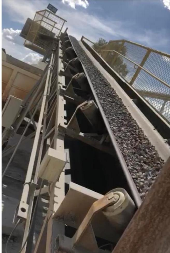
Figura 10 - Correia transportadora com balança integradora acoplada. Fonte: autor.
