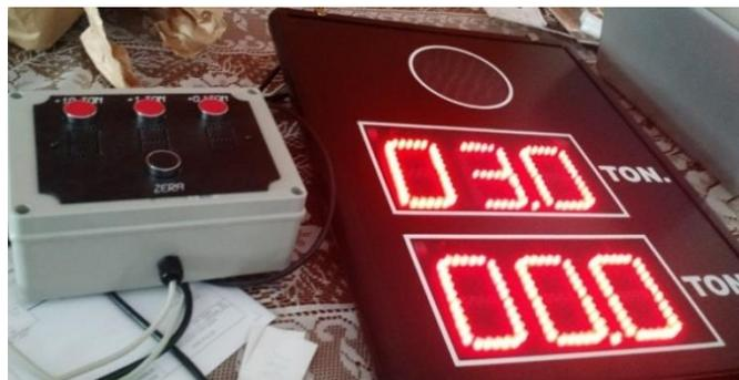
Figura 1 - Conjunto display programador de uma balança integradora. Fonte: autor.
