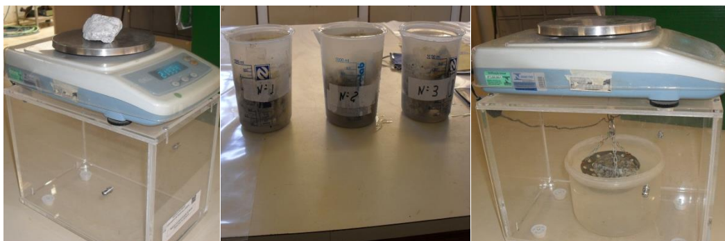
Figura 2.9– Balanças para a determinação da densidade, massa específica, absorção e porosidade
