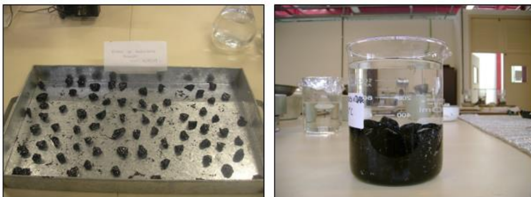
Figura 2.8 – Avaliação da adesividade entre o agregado e o ligante asfáltico CAP 50/70
