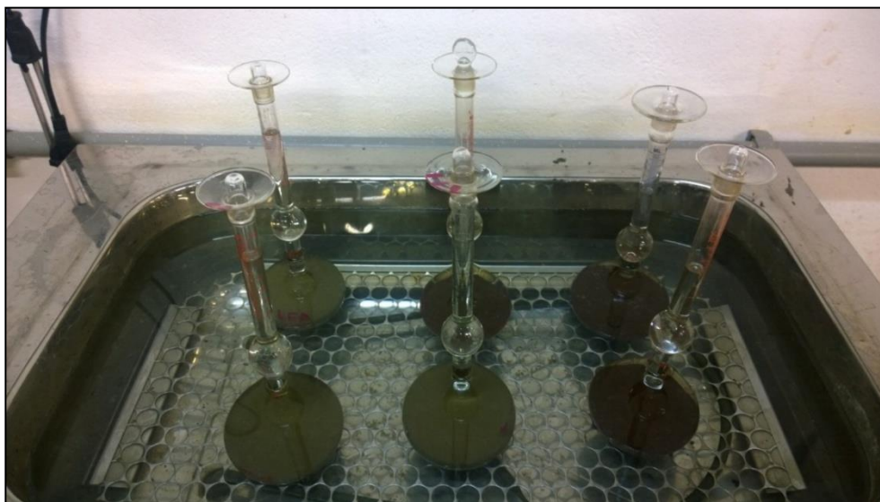
Figura 2.11 – Frascos Le Chatelier dentro do banho-maria para controle da temperatura durante a realização do ensaio
