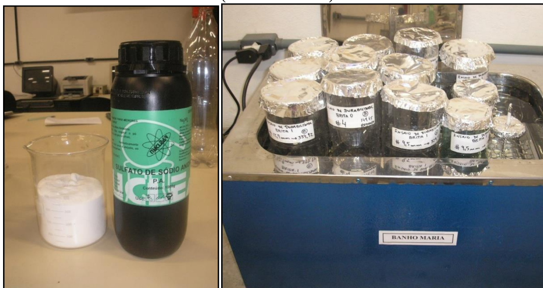
Figura 2.7 – Ensaio de Durabilidade com utilização de sulfato de sódio: detalhe das amostras em banho-maria (DNER-ME 089/94)
