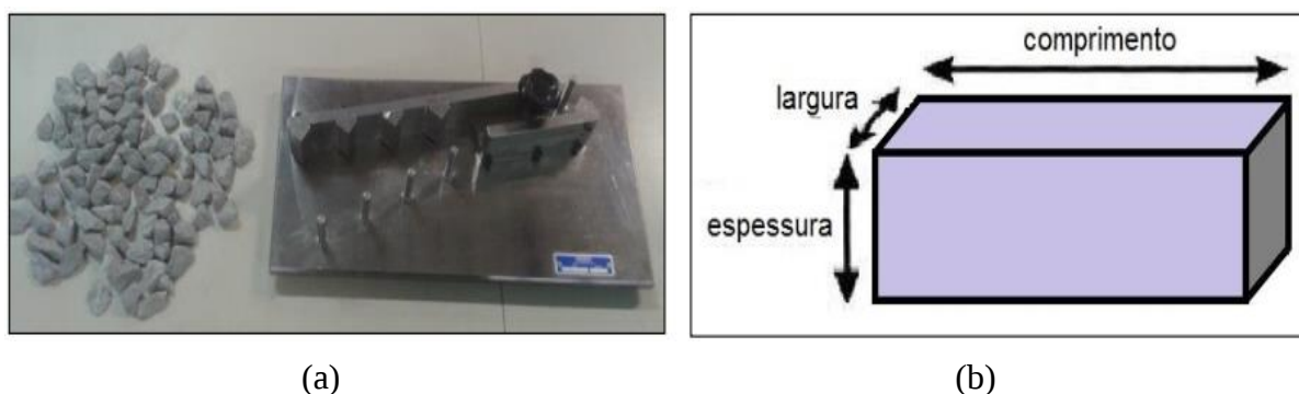
Figura 2.4 – Ensaio de partículas planas e alongadas: (a) Caliper; (b) Dimensões da partícula do agregado - Adaptado de Silva (2017)
