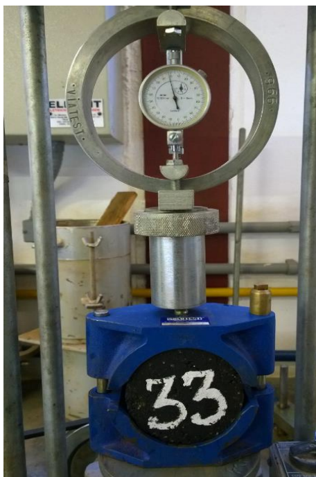
Figura 3.5 – Ensaio de estabilidade e fluência Marshall sendo realizado no Laboratório de Ferrovias e Asfalto
