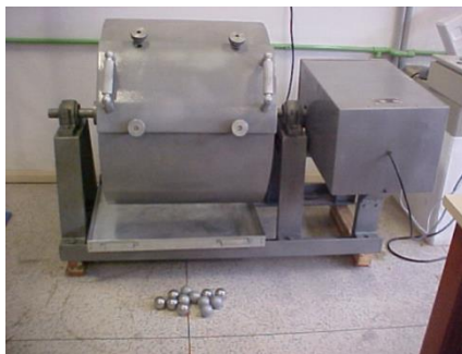
Figura 2.5 – Máquina “Los Angeles” e carga abrasiva utilizada nos ensaios.
