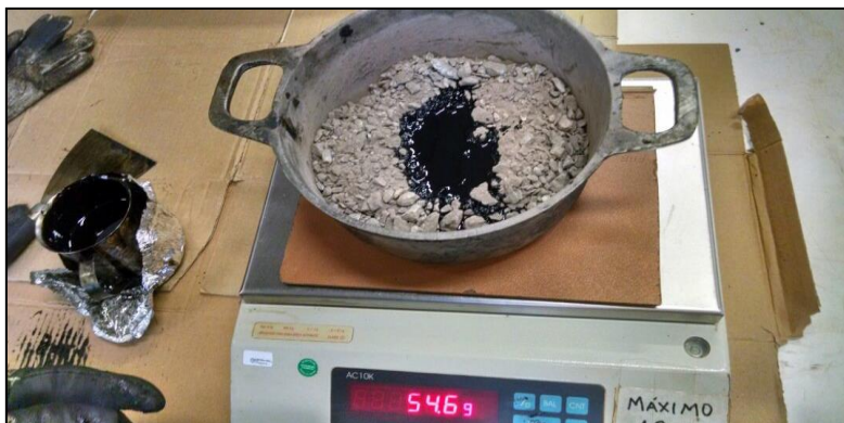
Figura 2.13 – Pesagem do ligante asfáltico utilizado na elaboração do corpo de prova
